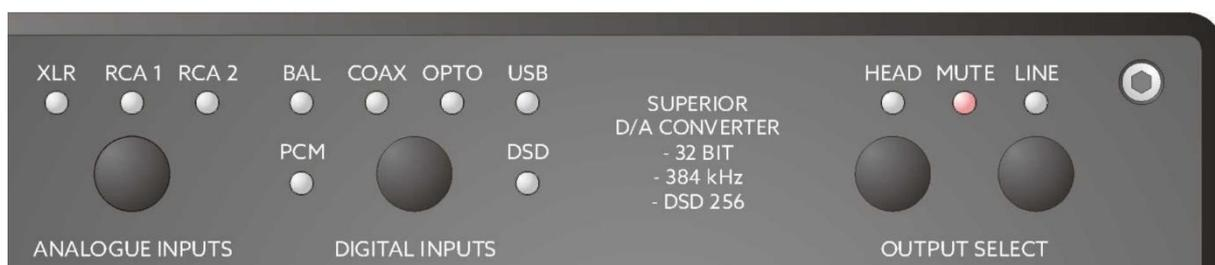
Mit den "ANALOGUE INPUTS" und "DIGITAL INPUTS" Tastern auf der Front des VIOLETRIC DHA V590<sup>2</sup> kann einer der drei analogen Eingänge oder einer der vier digitalen Eingänge per Kopfdruck aktiviert werden. Die entsprechende LED über dem Taster leuchtet.
