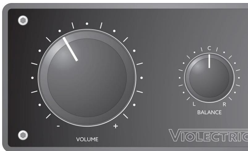
Mit dem "VOLUME"-Regler wird die gewünschte Lautstärke gemeinsam für den linken und rechten Kanal eingestellt. Die Lautstärke kann auch per Fernbedienung eingestellt werden, hierzu wird der Regler per Stellmotor bewegt. Während der **DHA V590<sup>2</sup>** ein "Standard" RK27 Poti besitzt, verfügt der **DHA V590<sup>2</sup> PRO** über eine anspruchsvolle 256-stufige Regelung per Reed-Relais.
