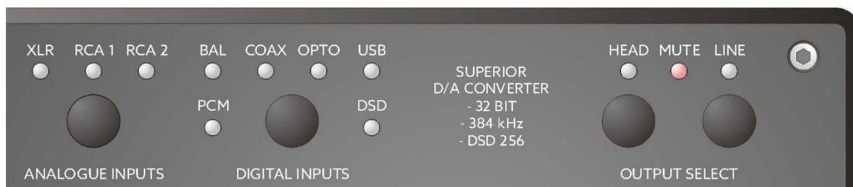
Durch einen Druck auf den mit "HEAD" bezeichneten Taster auf der Front können die Kopfhörerausgänge aktiviert / deaktiviert werden.
