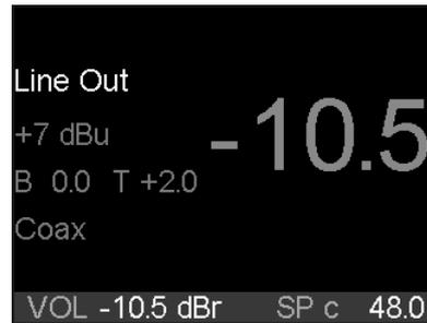
Um trotz fehlender Pegelanzeige eine Übersteuerung durch Volume, PEQ oder B/T erkennen zu können, ist die große Volume-Zahl mit der Over-Erkennung der analogen Ausgänge gekoppelt. Sie wechselt ihre Farbe bei Übersteuerung zu rot.
